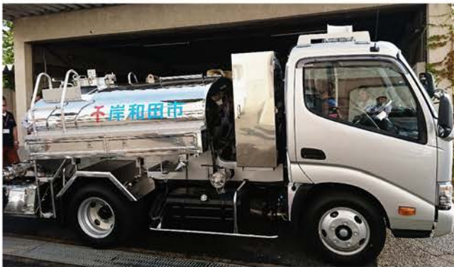
写真：加圧給水車
