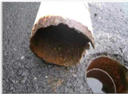
ポールの根腐れによる破断
